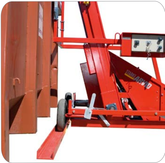
Sidoförflyttning med hjälp av U-profil
